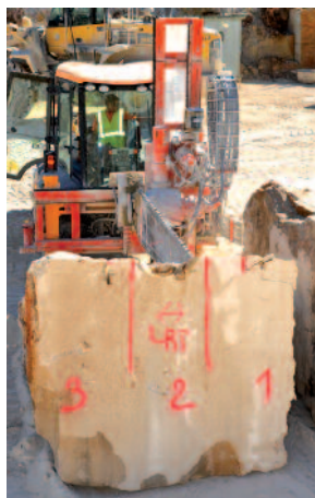
L'extraction de la pierre de Limeyrat s'effectue à l'aide de plusieurs haveuses autonomes Fantini. Certains blocs sont redébités à l'aide d'un bras Fantini monté sur un tractopelle JCB. Ci-dessous, Michel Raynaud a convié les invités à découvrir l'univers d'une carrière.
