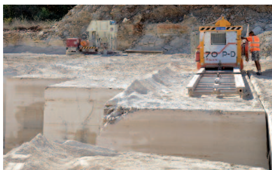
L'extraction de la pierre de Limeyrat s'effectue à l'aide de plusieurs haveuses autonomes Fantini. Certains blocs sont redébités à l'aide d'un bras Fantini monté sur un tractopelle JCB. Ci-dessous, Michel Raynaud a convié les invités à découvrir l'univers d'une carrière.
